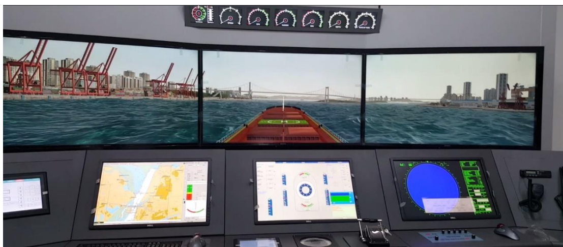
自主研发大型船舶操纵模拟器
